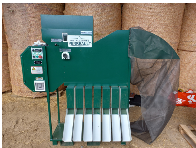
Le trieur aérodynamique, similaire à celui que possède Damien (cf ci-dessus)
