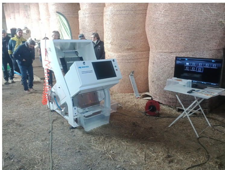
Le trieur optique, mis en route pour trier de l'orge
