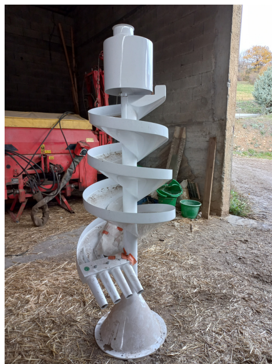
Le toboggan, un outil de fin de chaîne, pouvant être précis mais avec un faible débit.
