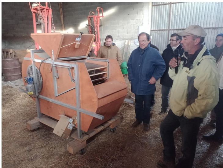
Le "ventoire amélioré" de Damien, avec deux moteurs indépendants pour le souffle et la vibration. Un outil très polyvalent avec ses nombreuses grilles disponibles.
