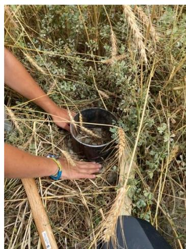
Figure 2. Mise en place du Beerkan test
