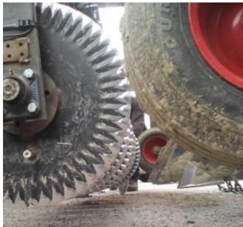
Image 10: Essais du 15/02/17 : position relative des disques et socs
