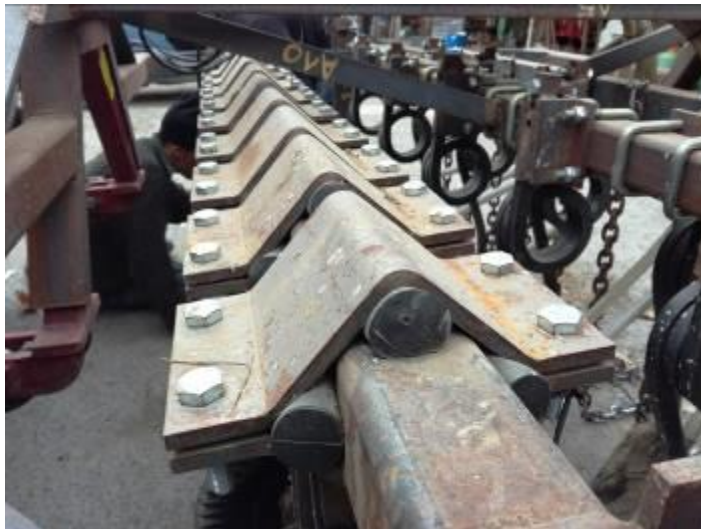
Image 11 : Bride des bras de disque - Boudins de caoutchouc
