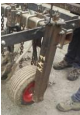
Image 3 : photo roue de jauge auto-construite
