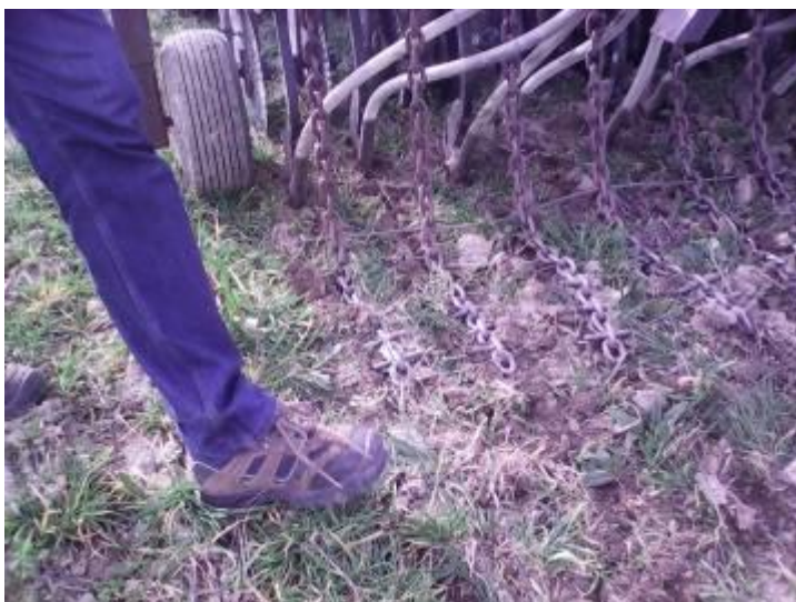
Image 6 : Essais du 15/02/17 : Sur le sillon créé les chaînes font retomber de la terre pour recouvrir la graine de 2 cm maxi
