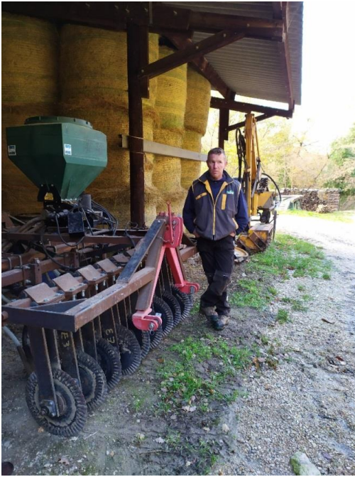
Figure 7: Semoir semis direct construit avec l'Atelier paysan
