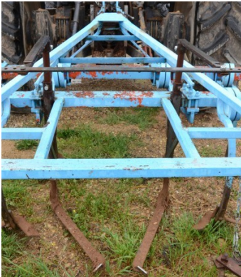
Ailes Bathelier montées sur une bineuse auto-construite (avec ailes patte d'oie). Crédit photo : Yann Sauvaire - PPAM Bio Conseil.
