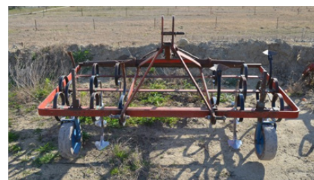
Bineuse PPAM sur base de vibroculteur léger avec des dents vibrantes et socs moyennement larges de type trèfle. Adapté à la culture de plantes annuelles sur butte, travail en sol léger (maraîcher) sur jeune plantation (1,5 ans max) ou sur des cultures qui restent basses. Crédit photo : Yann Sauvaire - PPAM Bio Conseil.
