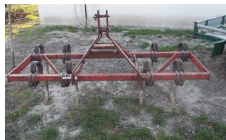
Bineuse PPAM sur base de cultivateur, plus solide, équipée de dents vibrantes à ressort de type « queue de cochon » avec des socs droits et une hauteur importante. Adapté au décompactage en sol lourd ou pris en masse, sur des cultures hautes (lavande-din). Crédit photo : Yann Sauvaire - PPAM Bio Conseil
